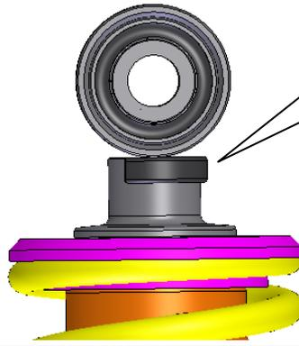
Achtung: Die Öffnung für die Zugstufeneinstellung muss zur Fahrzeugaußenseite zeigen!
