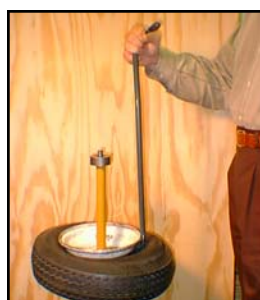
Photo A: Demount
