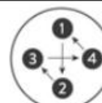
4 Lug Tightening Pattern
