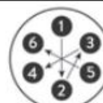
6 Lug Tightening Pattern
