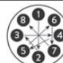
8 Lug Tightening Pattern
