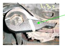
NEW RE-INDEXED TORSION BAR KEY BEING INSTALLED OVER THE STOCK TORSION BAR.
