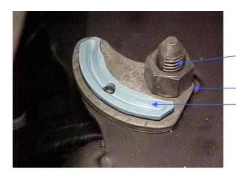
FACTORY UPPER CONTROL ARM TO FRAME ALIGNMENT ADJUSTING BOLT SHOWN FROM A 99-06 K-15.
