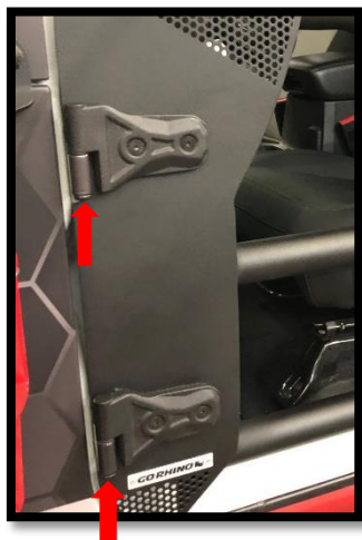
factory door retention nuts
