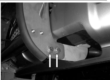
**STEP 6.** ATTACH THE GRILLE GUARD ASSEMBLY TO THE LOWER BRACKETS USING THE ½" FASTENERS.
