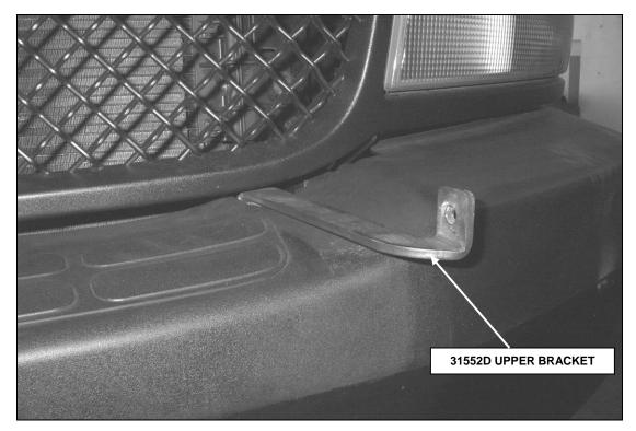
STEP-3 POSITION 31552D UPPER BRACKET BETWEEN THE GRILLE AND THE BUMPER.
