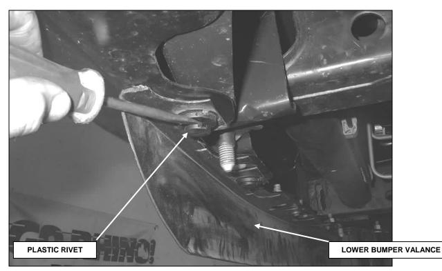
**STEP-1** REMOVE THE PLASTIC RIVETS, AND BUMPER VALANCE FROM THE BOTTOM OF THE BUMPER.
