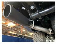
7. INSTALL DRIVER SIDE TAILPIPE HANGER BY SLIDING THE SIDE WITH THE HOLE BETWEEN THE TWO TABS WITH HOLES THAT PROTRUDE FROM THE FRAME JUST ABOVE THE DRIVER SIDE EXIT PIPE LOCATION. NEXT, INSTALL EXIT PIPES USING BAND CLAMPS.
