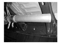
INSTALL HEADPIPE #A ONTO THE FACTORY EXTENSION PIPE. MAKE SURE THAT THE HEADPIPE IS STRAIGHT, NOT ANGLED UP OR DOWN. YOU MAY WANT TO LIGHTLY TAP ON THE END OF THE PIPE TO ENSURE A TIGHT FIT. CLAMP DOWN THE FACTORY CLAMP AT THE FRONT OF THE HEADPIPE. DO NOT TIGHTEN.
