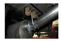
**4.** INSTALL OVERAXLE TAILPIPE # C INTO THE OUTLET OF THE MUFFLER 1½" TO 2". INSERT WELDED HANGERS INTO THE FACTORY RUBBER GROMMET. USE CLAMP #E TO ATTACH THE OVERAXLE PIPE TO THE MUFFLER OUTLET. DO NOT TIGHTEN.
