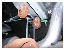
4. INSTALL OVERAXLE TAILPIPE # C INTO THE OUTLET OF THE MUFFLER 1½" TO 2". INSERT WELDED HANGERS INTO THE FACTORY RUBBER GROMMET. USE CLAMP #E TO ATTACH THE OVERAXLE PIPE TO THE MUFFLER OUTLET. DO NOT TIGHTEN.
