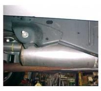
INSTALL MUFFLER # B ONTO HEADPIPE 1 ½" TO 2". USE CLAMP # E TO SECURE MUFFLER TO HEADPIPE. DO NOT TIGHTEN. USE A JACK STAND TO HOLD UP THE MUFFLER. MUFFLER INLET IS LOOKING INTO THE LOUVERS. OUTLET SHOULD BE AT THE 10 O'CLOCK POSITION.
