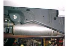
INSTALL MUFFLER # B ONTO HEADPIPE 1 ½" TO 2". USE CLAMP # E TO SECURE MUFFLER TO HEADPIPE. DO NOT TIGHTEN. USE A JACK STAND TO HOLD UP THE MUFFLER. MUFFLER INLET IS LOOKING INTO THE LOUVERS. OUTLET SHOULD BE AT THE 10 O'CLOCK POSITION.
