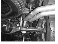
INSTALL THE DRIVERSIDE OVER AXLE TAILPIPE #D FROM THE REAR OF THE AXLE SLIP THE WELDED HANGERS INTO THE FACTORY RUBBER GROMMETS. THEN SLIP THE PIPE OVER THE OUTLET OF THE MUFFLER 1  $\frac{1}{2}$  TO 2". USE CLAMP # G TO SERCURE TAILPIPES TO THE MUFFLER. DO NOT TIGHTEN.
