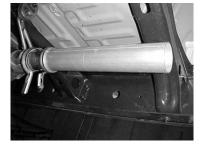
INSTALL HEADPIPE #A ONTO THE FACTORY EXTENSION PIPE. MAKE SURE THAT THE HEADPIPE IS STRAIGHT, NOT ANGLED UP OR DOWN. YOU MAY WANT TO LIGHTLY TAP ON THE END OF THE PIPE TO
