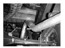
SLIP THE MUFFLER #B ONTO THE HEAD PIPE 1 1/2 TO 2". USE CLAMP #F TO ATTACH THE MUFFLER TO THE HEADPIPE. DO NOT TIGHTEN. MAKE SURE THE MUFFLER OUTLETS ARE LEVEL. USE A JACK STAND TO SUPPORT THE
