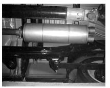
**INSTALL MUFFLER # A WITH** THE INLET TOWARDS THE MOTOR. INLET HAS LOUVERS INSIDE FACING TOWARDS THE MOTOR. USE A JACK STAND TO SUPPORT THE MUFFLER. USE CLAMP # F TO SECURE MUFFLER TO THE STOCK HEADPIPE. DO NOT TIGHTEN .
