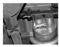
INSTALL EXIT PIPES #E ONTO
