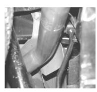
FOR AN EASIER INSTALLATION OF THE TAILPIPE DISCONNECT THE LOWER REAR SHOCK MOUNT ON THE PASSENGER SIDE.
