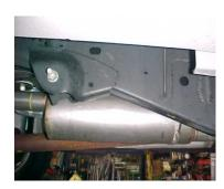
INSTALL MUFFLER # B ONTO HEADPIPE 1 ½" TO 2". USE CLAMP # E TO SECURE MUFFLER TO HEADPIPE. DO NOT TIGHTEN. USE A JACK STAND TO HOLD UP THE MUFFLER. MUFFLER INLET IS LOOKING INTO THE LOUVERS. OUTLET SHOULD BE AT THE 12 O'CLOCK POSITION.
