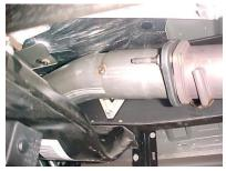
RE-INSTALL YOUR CATALYTIC CONVERTER TO THE NEW DOWN PIPE. USING YOU FACTORY NUTS.
