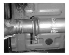
INSTALL HEADPIPE #A. MAKE SURE THE HEADPIPE IS STRAIGHT. YOU MAY WANT TO GENTLY TAP THE END OF THE HEADPIPE TO ENSURE A TIGHT FIT. CLAMP DOWNTHE FACTORY CLAMP AT THE FRONT OF THE HEADPIPE. DO NOT TIGHTEN.
