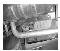
INSERT THE REAR TAILPIPE HANGER INTO THE FACTORY RUBBER GROMMET.
