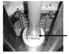
INSTALL MUFFLER # A ONTO THE STOCK HEADPIPE. SUPPORT THE MUFFLER USING A JACK STAND. INSTALL FRONT MUFFLER HANGER #F ONTO THE INLET OF THE MUFFLER. MUFFLER INLET IS LOOKING INTO LOUVERS.
