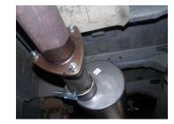
SLIDE MUFFLER ONTO THE FRONT HEADPIPE WITH THE INLET TOWARDS THE CONVERTER (MUFFLER INLET IS LOOKING INTO LOUVERS). USE THE JACK STAND TO SUPPORT THE MUFFLER AND CLAMP USING #G. DO NOT TIGHTEN. MUFFLER OUTLET SHOULD BE POSITIONED AT 9 O'CLOCK
