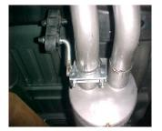
INSTALL REAR MUFFLER HANGER # E ONTO DRIVER SIDE OUTLET OF THE MUFFLER AND INSERT THE WELDED HANGER INTO RUBBER GROMMET.
