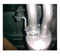
INSTALL REAR MUFFLER HANGER # H ONTO DRIVER SIDE OUTLET OF THE MUFFLER AND INSERT THE WELDED HANGER INTO RUBBER GROMMET.
