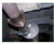
SLIDE MUFFLER ONTO THE FRONT HEADPIPE WITH THE INLET TOWARDS THE CONVERTER (MUFFLER INLET IS LOOKING INTO LOUVERS). USE THE JACK STAND TO SUPPORT THE MUFFLER AND CLAMP USING #G. DO NOT TIGHTEN. MUFFLER OUTLET SHOULD BE POSITIONED AT 9 O'CLOCK
