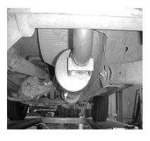
INSTALL THE MUFFLER TO HEADPIPE AND USE CLAMP #E TO ATTACH. PUSH MUFFLER TILL IT HITS THE ALIGNMENT PIN. YOU WILL NEED TO ROTATE THE MUFFLER TO A 2 O'CLOCK POSITION. MUFFLER INLET IS LOOKING INTO THE LOUVERS.
