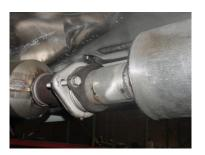
INSTALL HEADPIPE #A. UNTO STOCK FLANGE. DO NOT TIGHTEN.
