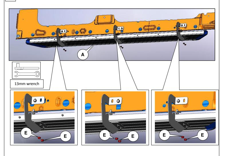
4 REPEAT STEPS 1-3 FOR PASSENGER SIDE USING BRACKET C.
