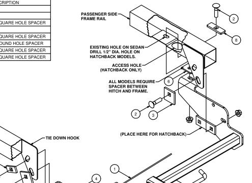
HITCH WEIGHT: <u>25</u> LBS. INSTALL TIME: <u>30</u> MINUTES INSTALL NOTES: -DRILLING REQUIRED
