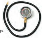
**2010 CYLINDER LEAKAGE TESTER**
