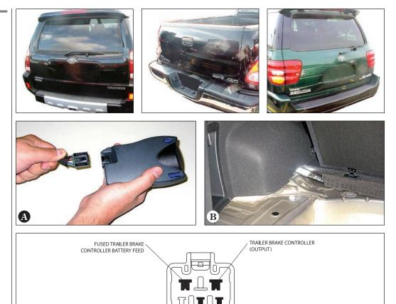
VEHICLE STOP LAMP SWITCH TO BRAKE CONTROLLER (INPUT)
