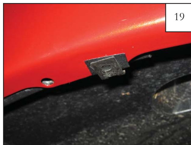
Install Clip (CL1-0022) over Tab (MT1-0014).
