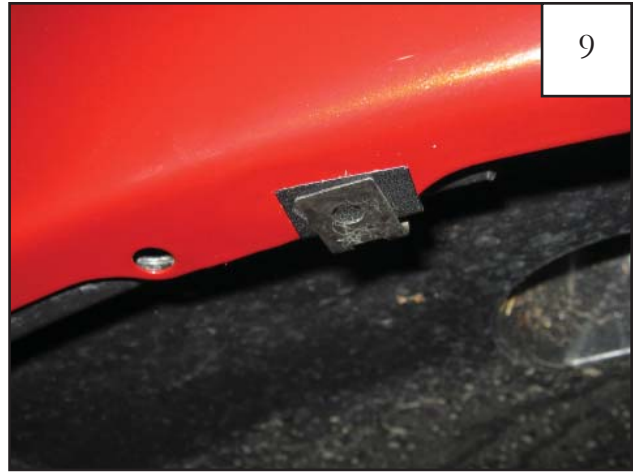
Install Clip (CL1-0022) over Tab (MT1-0014).
