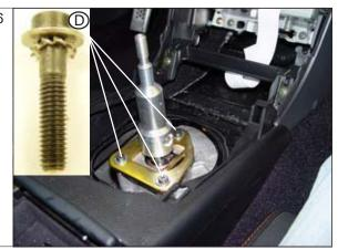
STEP 17. Reinstall shift linkage bolt.
