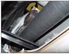
STEP 10. Remove shift linkage bolt.
