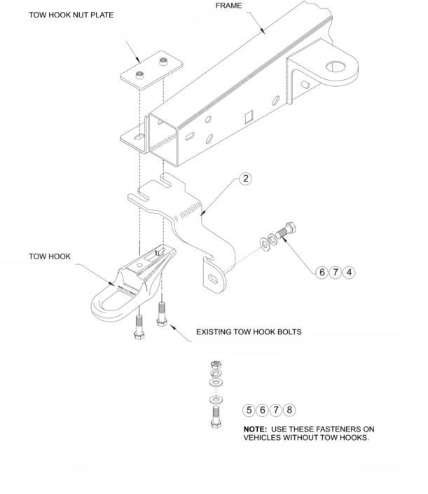
FIGURE 1 PASSENGER SIDE SHOWN, DRIVER SIDE OPPOSITE
