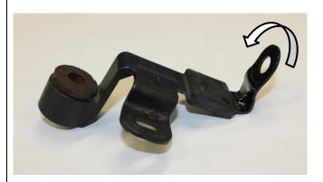
42. Re-install OEM fan connector bracket to fan clutch.
