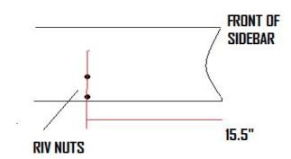
NOTE: TO ESTABLISH FRONT OF THE SIDEBAR- AT THE BOTTOM OF THE TUBE YOU WILL HAVE THE RIV NUTS 15.5" FROM THE END. THE TUBE WILL FACE INWARD.
