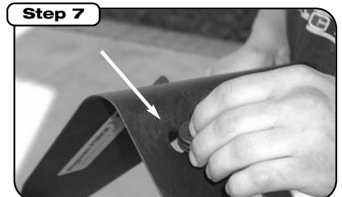
Insert rubber grommet.
