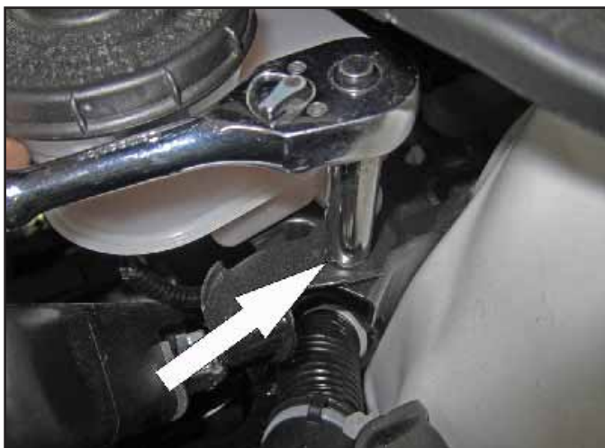
m. Remove the upper 10mm ECU bolt.
