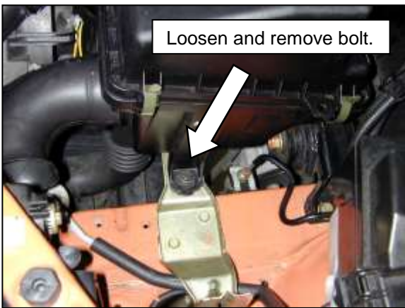
e. Loosen and remove bolt.
