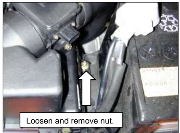
f. Loosen and remove nut.
