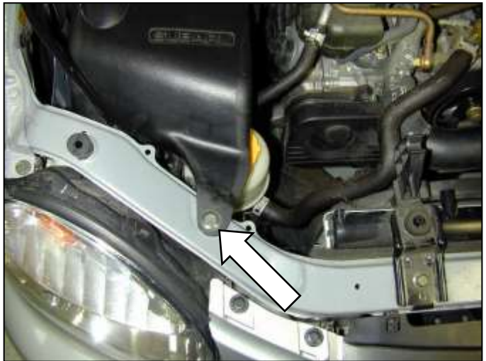
b. Loosen and remove bolt.
