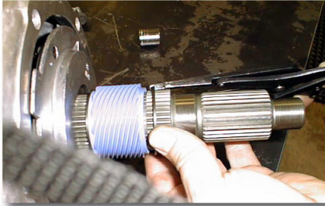
(Fig. 9A) Speed-o-Ring Gear Install
